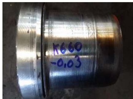
Eixo (LOA) com medida da sede do rolamento fora da norma. Norma aplicada 60 k6 de + 0,002 até + 0,021. Encontrado: 60 - 0,030.
