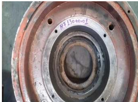
Tampa (LA) com medida da sede do rolamento dentro da norma. Norma aplicada 130 H7 de 0,000 até + 0,040. Encontrado: 130 + 0,010.
