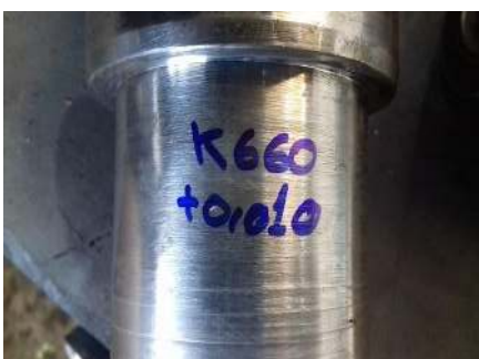
Eixo (LA) com medida da sede do rolamento dentro da norma. Norma aplicada 60 k6 de + 0,002 até + 0,021. Encontrado: 60 + 0,010.
