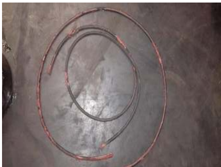
Anéis O'Ring de 260 x 5mm, deformados.
