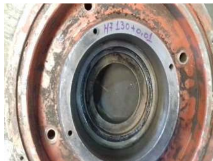
Tampa (LOA) com medida da sede do rolamento dentro da norma. Norma aplicada 130 H7 de 0,000 até + 0,040. Encontrado: 72 + 0,010.
