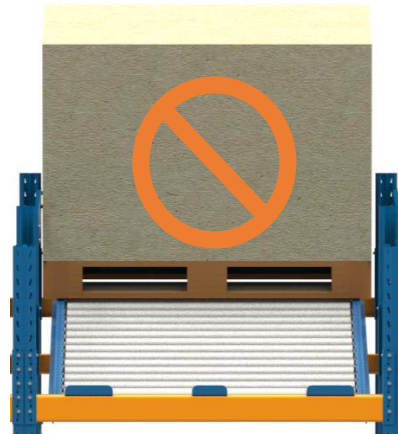
Figura 47 – Forma errada de posicionar o pallet na estrutura Dinâmica
