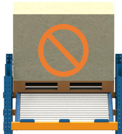
Figura 41 – Forma errada de posicionar o pallet na estrutura Push back
