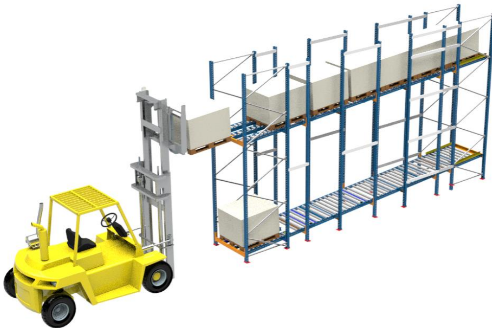
Figura 51 – Descarregamento estrutura dinâmica
