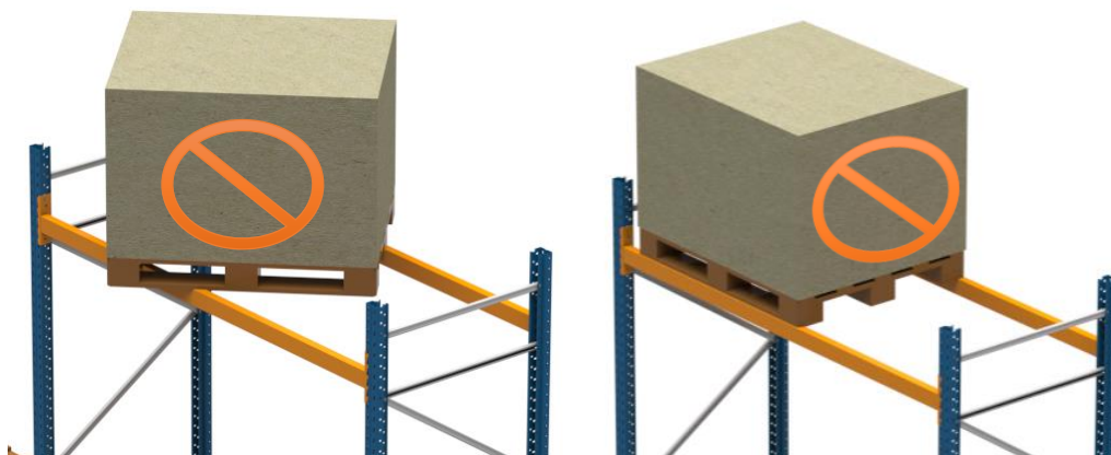
Figura 8 - Posicionamento incorreto no porta pallets
