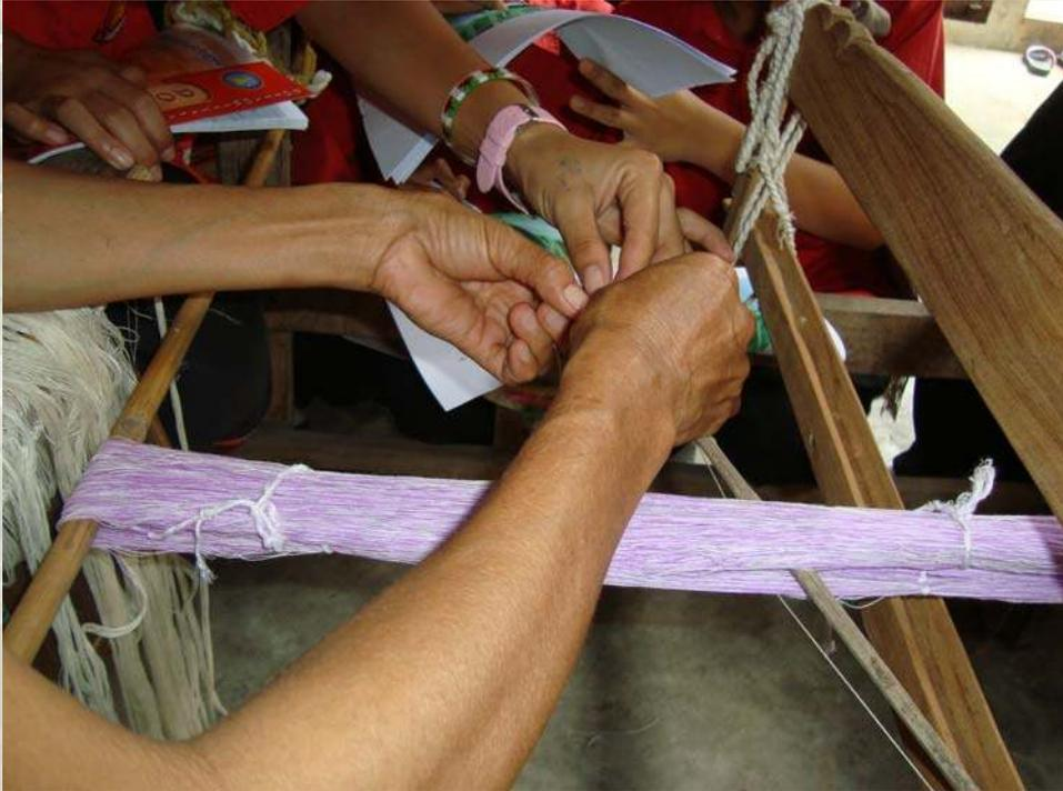
ภาพที่ 69 ขั้นตอนที่ 2 ใช้เส้นฝ้ายมัดไม้ไผ่เหลาติดกับฝ้ายเส้นยืนเพื่อไม่ให้หลุดออกจากกัน
