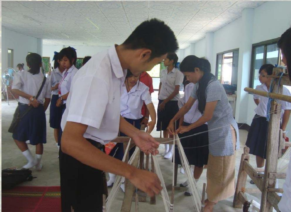
ภาพที่ 57 ขั้นตอนที่ 4 ดึงฝ้ายเส้นยืนจากซี่ฝักขอที่ 2 ด้านขวามือมาคล้องซี่ฝักที่ 4 ด้านซ้ายมือ
