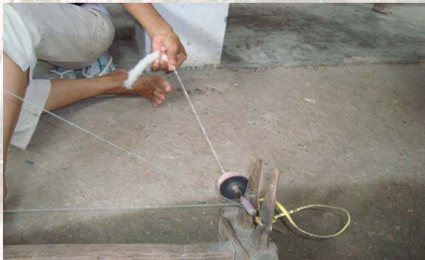
ภาพที่ 26 ขั้นตอนที่ 3 มือซ้ายค่อย ๆ ปลดปล่อยฝ้ายออกทีละน้อยพร้อม ๆ กับใช้นิ้วหัวแม่มือและ
