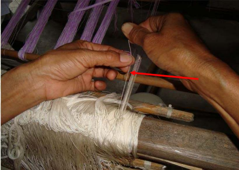
ภาพที่ 77 ขั้นตอนที่ 10 ดึงเส้นฝ้ายจากเส้นยืนออกมาทีละเส้น โดยเลือกเส้นหน้าสุดทุกครั้ง
