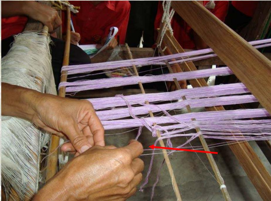
ภาพที่ 75 ขั้นตอนที่ 8 นำฝ้ายจากเส้นยืนมาต่อกับฝ้ายเส้นยืนเดิมที่ติดอยู่กับฟืม
