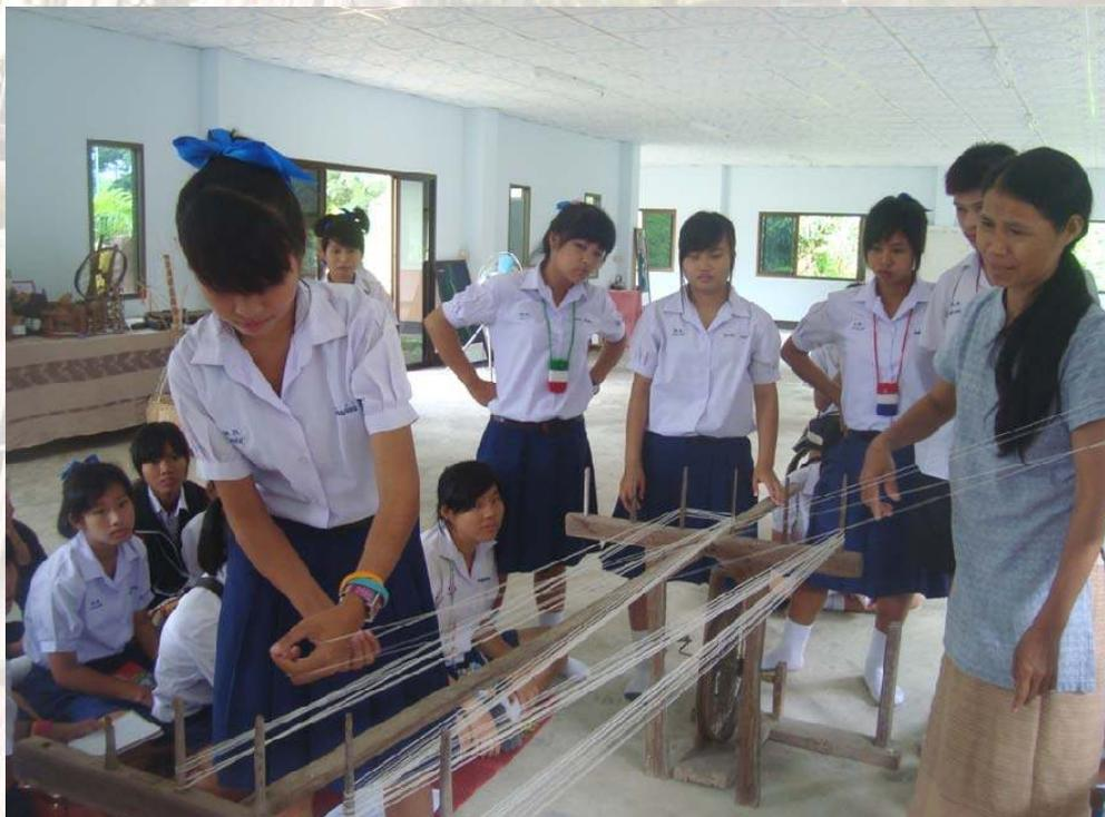
ภาพที่ 58 ขั้นตอนที่ 5 ดึงฝ้ายเส้นยืนจากซี่ฝักขอที่ 4 ด้านซ้ายมือมาคล้องซี่ฝักขอที่ 4 ด้านขวามือ
