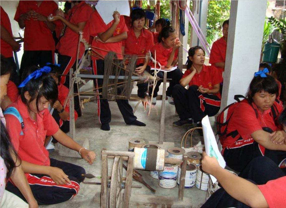
ภาพที่ 48 ขั้นตอนที่ 5 กรอฝ้ายให้เต็มแกนหลอดเพื่อนำไปใช้ทอเป็นเส้นพุ่ง
