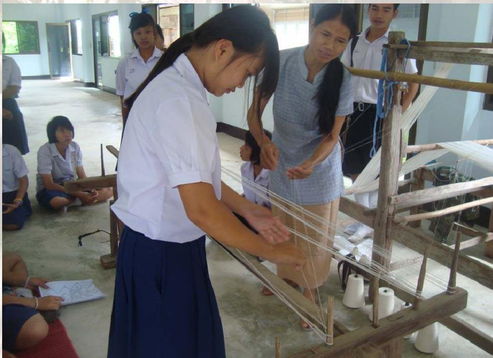
ภาพที่ 60 ขั้นตอนที่ 7 ดึงฝ้ายเส้นยืนจากซี่ฝักขอที่ 4 ด้านขวามือ ให้ไขว้กัน เหมือนเลข 8
