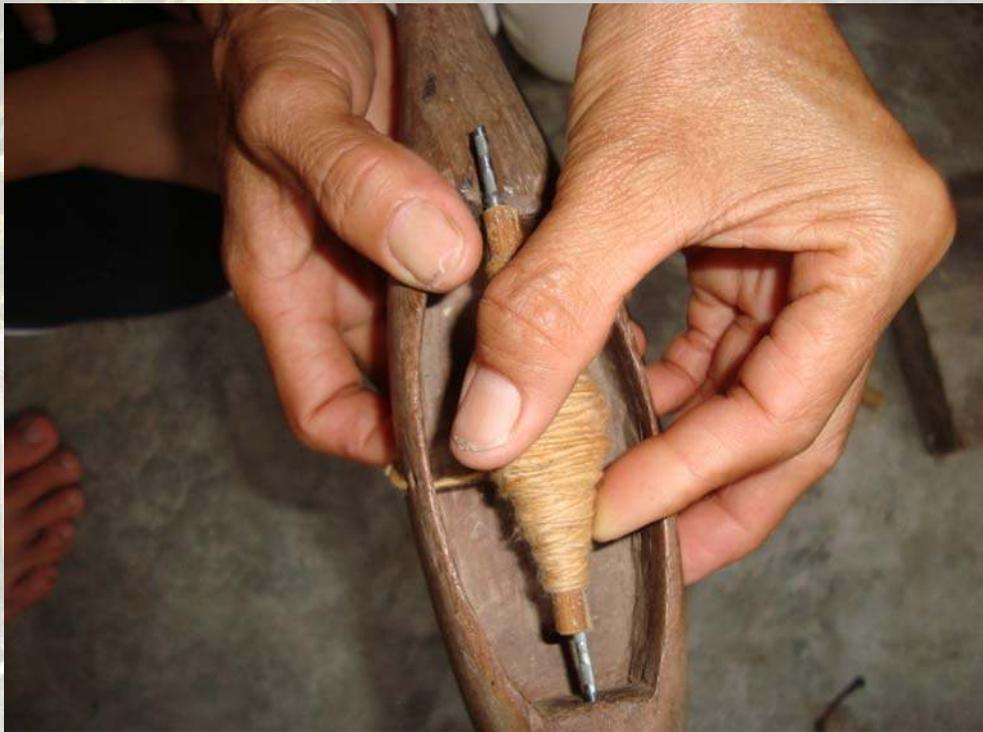
ภาพที่ 100 ขั้นตอนที่ 5 นำหลอดสายพร้อมไม้ขั้วใส่เข้าไปข้างในกระสวย
