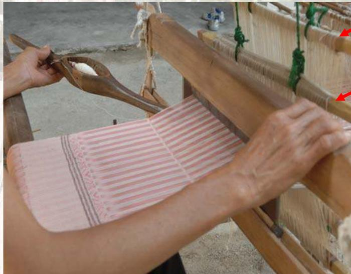
ภาพที่ 85 เมื่อเหยียบไม้เหยียบฮุกอันหนึ่งลง เขาฮุกก็จะถูกทำให้ต่างระดับกัน โดยอันหนึ่งยกอีกอันหนึ่งจะต่ำสลับกัน ใช้กระสวยพุ่งลอดผ่านไปมาตลอดแนว เวลาทอ
