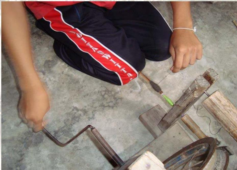
ภาพที่ 47 ขั้นตอนที่ 4 เริ่มกรอฝ้าย โดยมีมือขวาหมุนเครื่องกรอฝ้าย(หางเหน)
