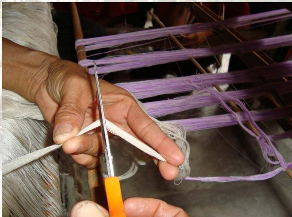
ภาพที่ 72 ขั้นตอนที่ 5 ใช้กรรไกรตัดเส้นฝ้ายย่นให้เสมอก่อนที่จะสับหูก
