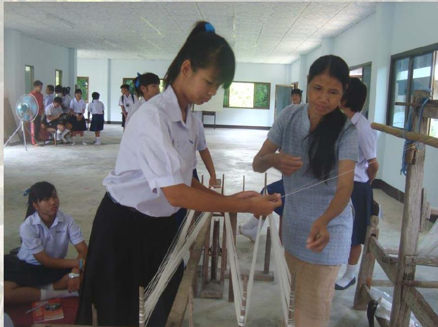
ภาพที่ 65 ขั้นตอนที่ 12 ดึงฝ้ายเส้นยืนคล้องซี่ฝักขothi 1 ด้านซ้ายมือไปคล้องซี่ฝักขothi 1 ด้านขวามือ นับเป็นการวนเครื่องหูกได้ 1 รอบ การวนหูกรอบต่อไป ก็เริ่มต้นที่ขั้นตอนที่ 2 ถึงขั้นตอนที่ 12 นับเป็นการวนเครื่องหูกได้ 2 รอบ การวนที่รอบขึ้นอยู่กับฝีมว่าจะใช้ฝีมทั้งหมดกี่หลบ
