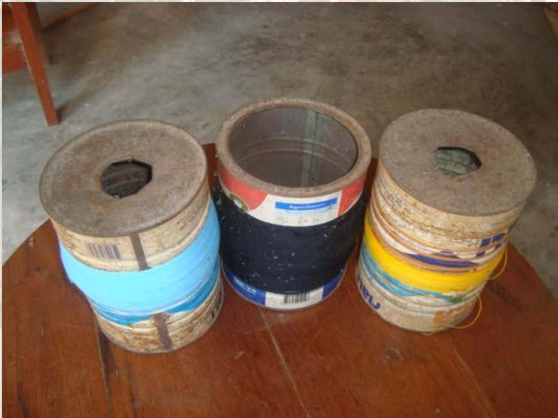
ภาพที่ 35 ก๊วัก มะกักหรือ ป่ากวก ที่ดัดแปลงโดยใช้ กระป๋องนมหรือกระป๋องสี ที่ใช้แล้ว
