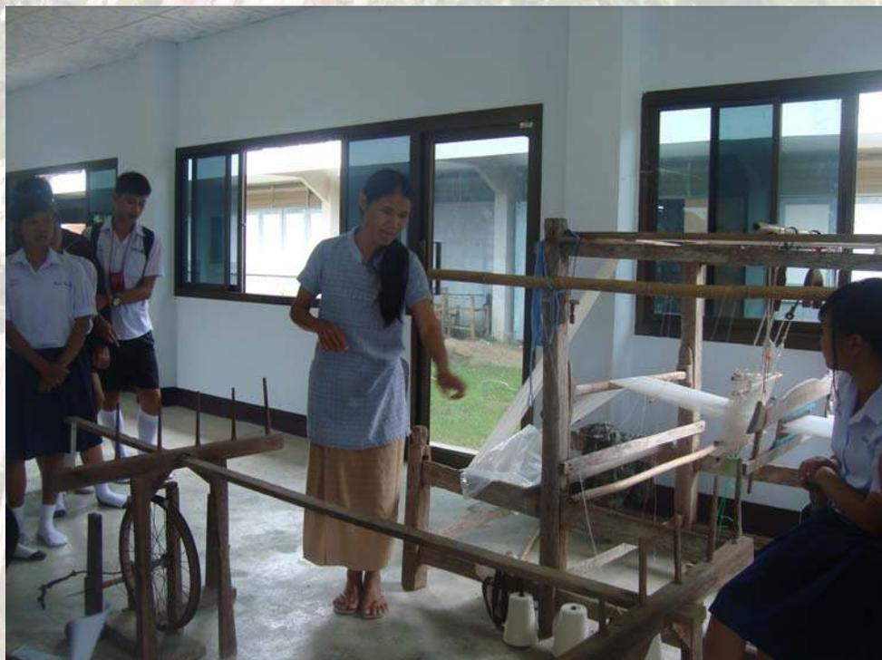
ภาพที่ 50 ผื่อหรือผักขอที่ทำหน้าที่กำหนดขนาดของเส้นด้าย
