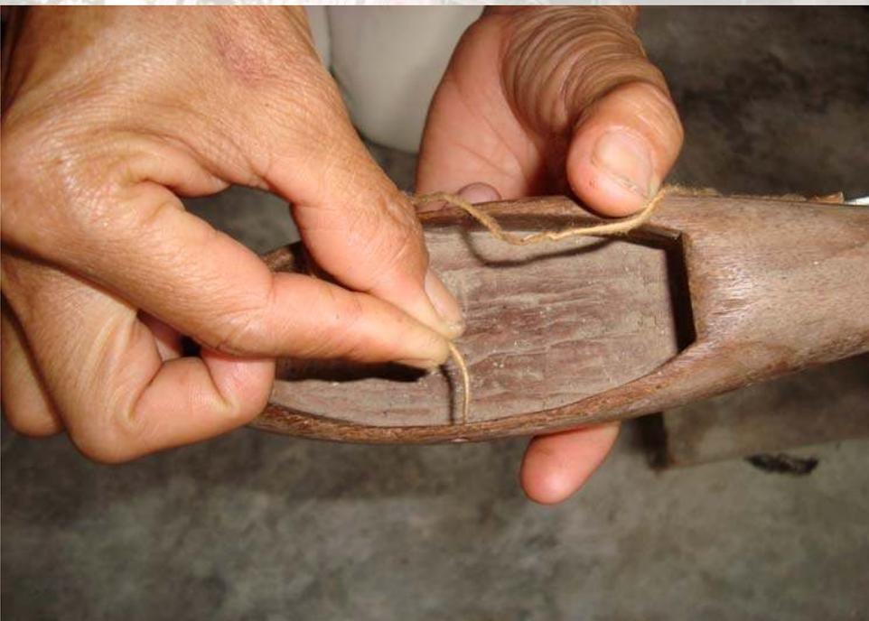
ภาพที่ 99 ขั้นตอนที่ 4 นำเส้นฝ้ายจากหลอดฝ้ายสอดเข้าไปในรูกระสวย
