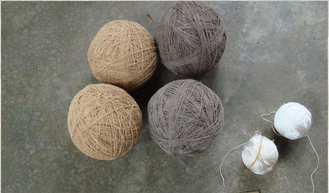
ภาพที่ 111 ใจด้ายเมื่อผ่านการกรอด้วยจะมีลักษณะเหมือนลูกบอลสะดวกต่อการใช้งาน และทำให้ด้ายไม่พันกัน
