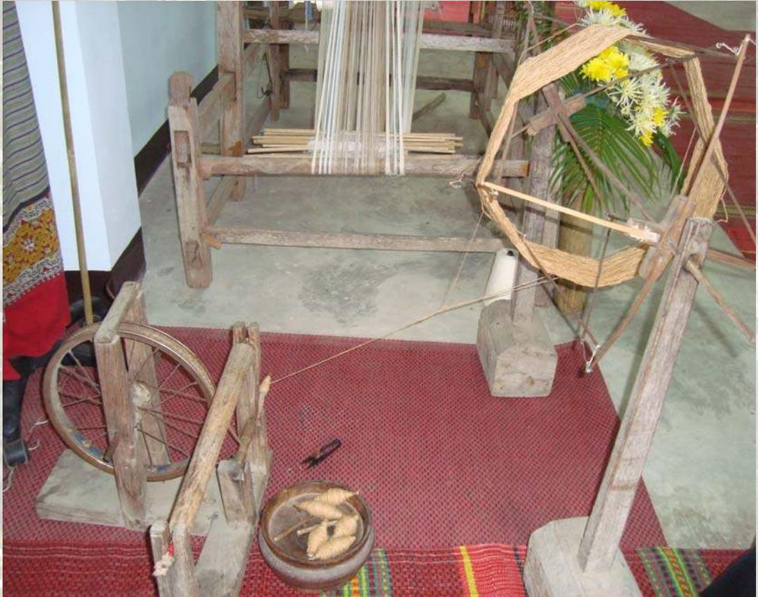
ภาพที่ 42 วัสดุและอุปกรณ์ในการกรอฝ้าย ประกอบด้วย กวาง เครื่องกรอฝ้าย(หางเห็น)
