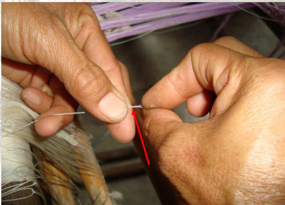
ภาพที่ 76 ขั้นตอนที่ 9 ใช้วิธีการต่อแบบทาบเส้น
