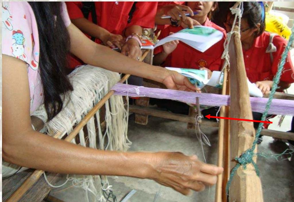
ภาพที่ 68 ขั้นตอนที่ 1 นำไม้ไผ่เหลามาสอดกับเส้นฝ้ายยืน(ที่อยู่ด้านบน) ที่ได้จากการง้วนทูก
