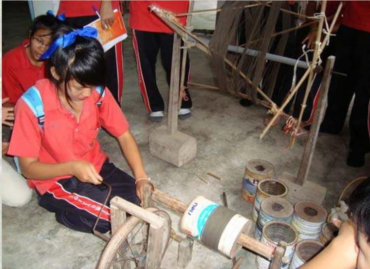
ภาพที่ 44 ขั้นตอนที่ 1 นำเส้นฝ้ายที่กวักแล้วมากรอใส่เครื่องกรอฝ้าย
