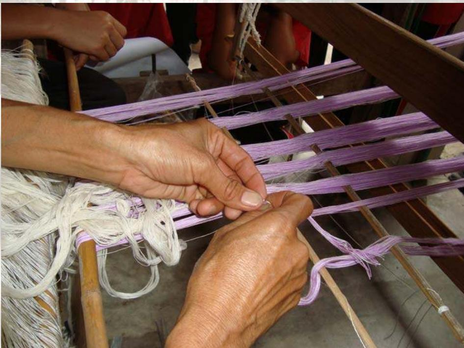
ภาพที่ 74 ขั้นตอนที่ 7 ดึงเส้นฝ้ายจากเส้นขึ้นออกมาที่ละเส้น โดยเลือกเส้นหน้าสุด
