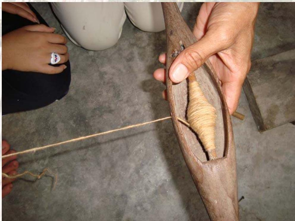
ภาพที่ 101 ขั้นตอนที่ 6 ดึงเส้นสายที่สอดไว้รูกระสวยออกมาพร้อมที่จะนำไปทอเป็นเส้นด้ายพุ่ง
