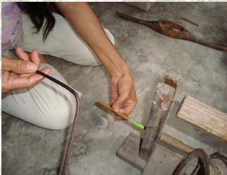
ภาพที่ 45 ขั้นตอนที่ 2 นำแกนหลอดมาใส่ที่เหล็กคันใน มือซ้ายดึงเส้นฝ้ายที่กวักแล้วมาพันให้ติดกับแกนหลอดให้แน่น
